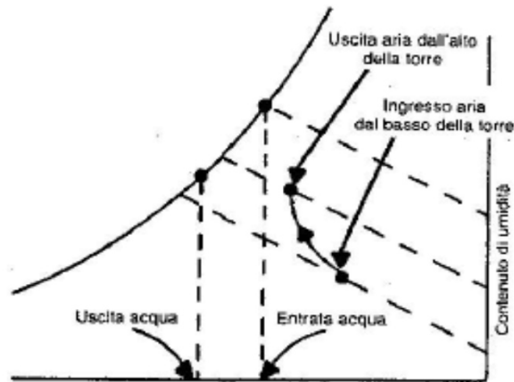
Figura 7.11 – Condizioni dell'aria e dell'acqua di una torre di raffreddamento del tipo a controcorrente.
