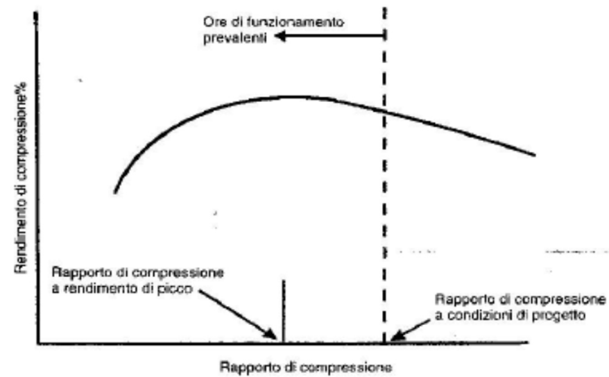
Figura 5.8 – Scelta di un compressore quando il suo rendimento di picco avviene a un valore inferiore al rapporto di compressione di progetto.
